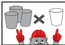
Mezcle 3 parte de FIJACER por 1 parte de agua limpia y mezcle hasta tener una masa homogénea y libre de grumos.
